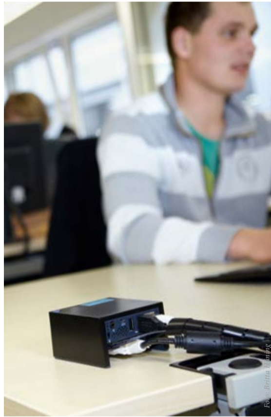
Ein kleiner Kasten ersetzt Computer mit Festplatte, Grafikkarten, Lüfter und DVD-Laufwerk.
