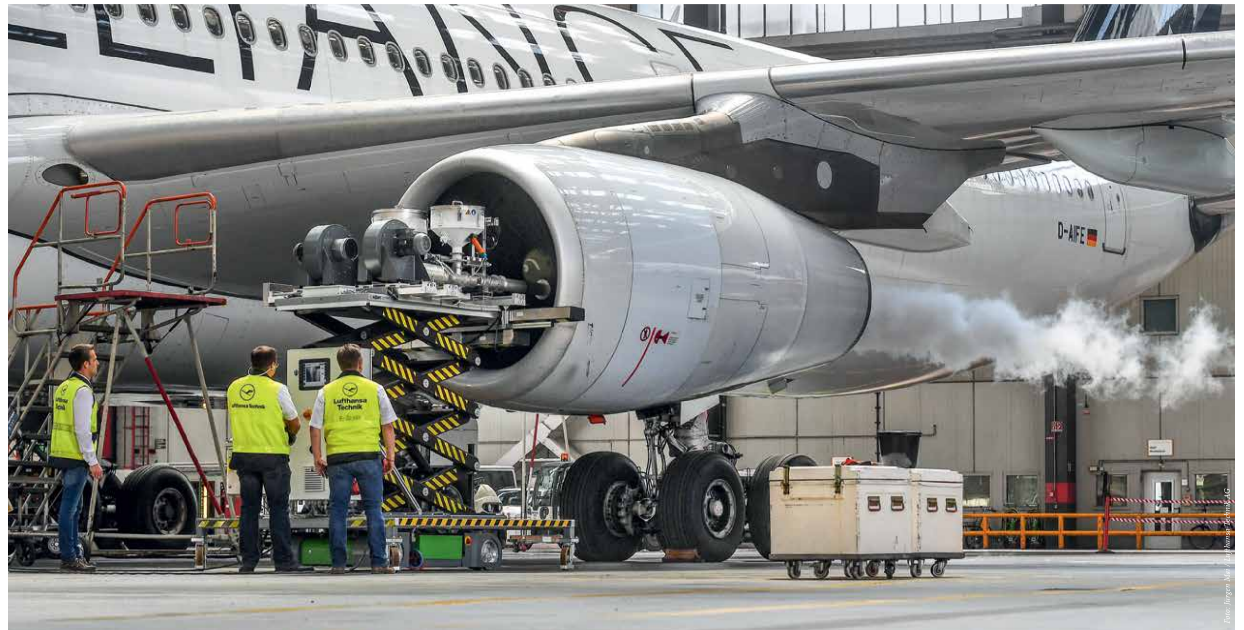
Dank höhenverstellbarer Scherenhubbhühne eignet sich die Reinigungsanlage für Triebwerke jeder Größe und Höhe. Mehrere Airlines haben bereits Interesse an der patentierten Entwicklung signalisiert.
